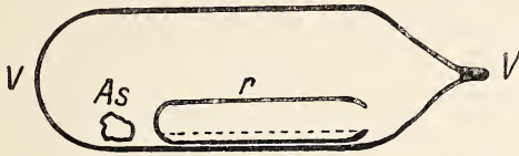
Fig. 1. Natürliche Größe. V = Vakuumrohr, As = Arsenstückchen, r = Röhrchen für Speiskobalt, Kobalt oder Eisen.
