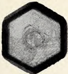
Fig. 2. Kopfansicht eines unter Belastung (190 g) gewachsenen Kristalls. Die dunklen Partien entsprechen dem neuen Wachstum (2fache Vergrößerung).
